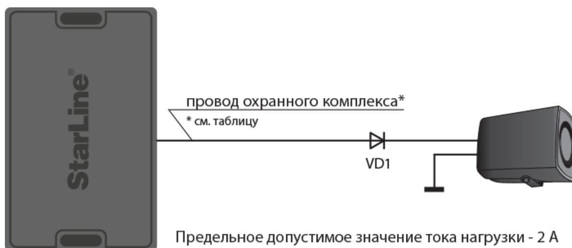
Рис. 1. Схема подключения автомобильной сирены
